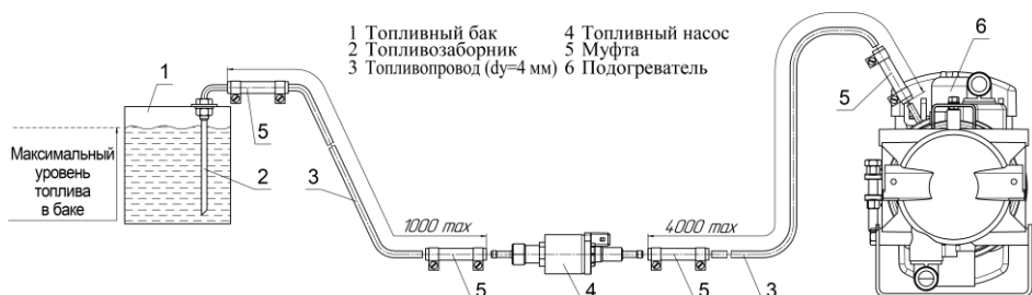
Рис. 9.5. Схема присоединения топливopовода
